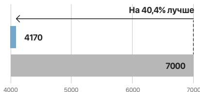
Динамическая вязкость при холодном пуске при -25°C (CCS), cП (чем ниже, тем лучше)
